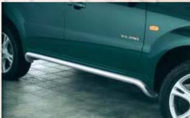
9 Side bar shaped защитная боковая труба (Согнуто) not matching the original side step Не подходит с оригинальной подножкой пластмассы Stainless steel/ нерж. сталь 197 4053
